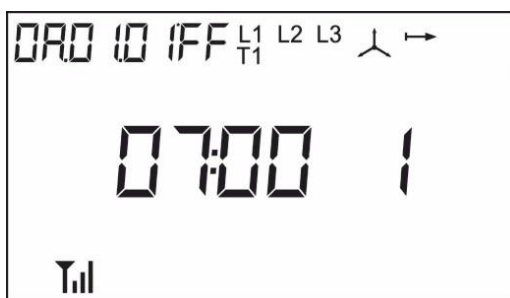
Рисунок 2.14 – Меню 11 кадр 11. Начальный кадр подгруппы. Время начала тарифной зоны 1 с указанием номера тарифа.
