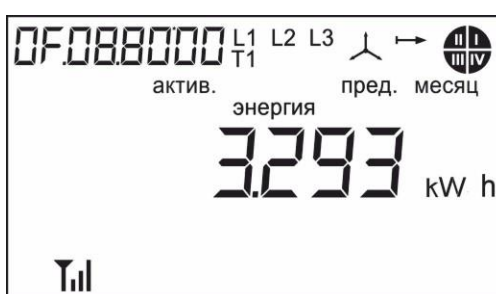
Рисунок 2.7 – Меню 1 Кадр 6. Энергия активная нарастающим итогом всего за предыдущий месяц, в кВт·ч
