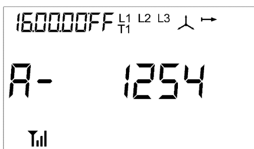
Рисунок 2.16 – Меню 12 кадр 2. Адрес счетчика
