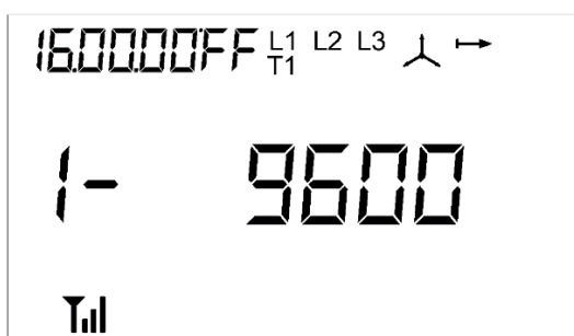
Рисунок 2.17 – Меню 12 кадр 3. Скорость обмена по оптическому порту.
