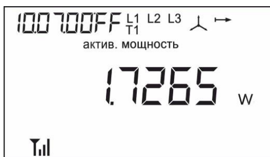
Рисунок 2.9 – Меню 10 кадр 1. Мощность активная всего, в Вт
